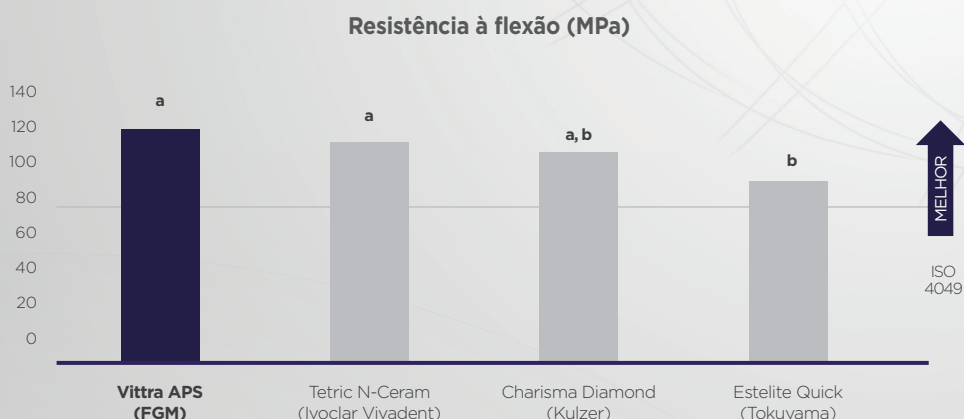
Figura 1: Resistência à flexão em três pontos (média e desvio padrão em MPa) de diferentes compósitos (n=10) (ANOVA de 1 fator e teste de Tukey; p<0,05 ).
