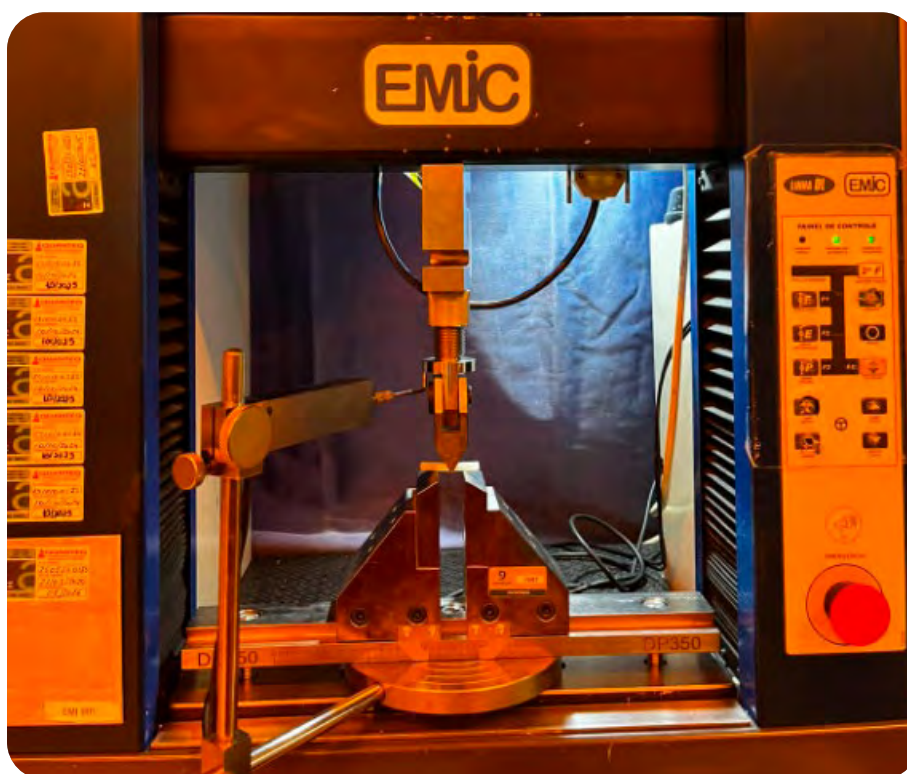
Imagem 8 - Máquina universal de ensaios (EMIC, modelo DL 2000)
