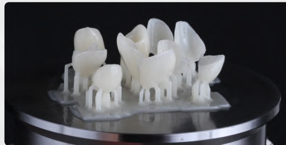
5 | Elementos temporários confeccionados via impressão 3D, com a resina Voxelprint TEMP, posicionados na plataforma da impressora.
