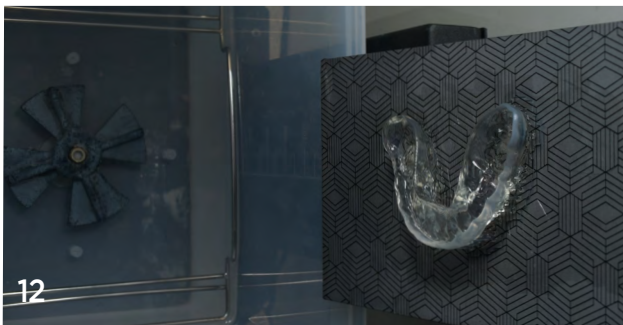
12 | Etapa de limpeza da placa oclusal realizada em cabine específica, visando à remoção de resíduos de resina não polimerizada.
