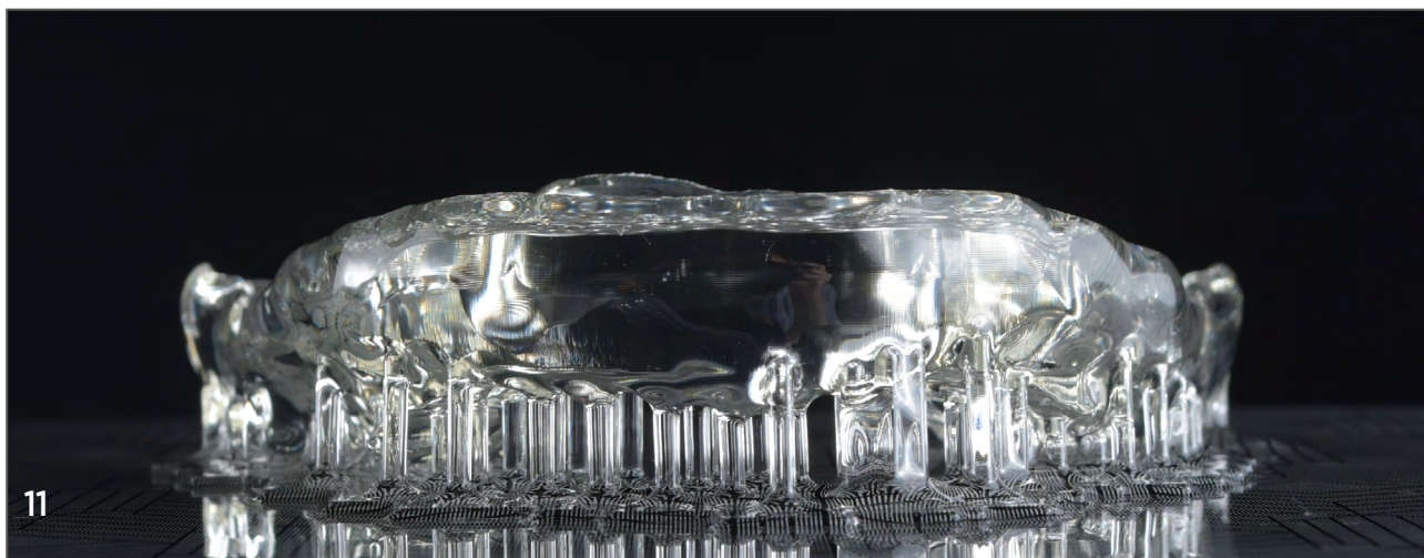
11 | Placa oclusal posicionada na plataforma de impressão após conclusão do processo de manufatura aditiva.
