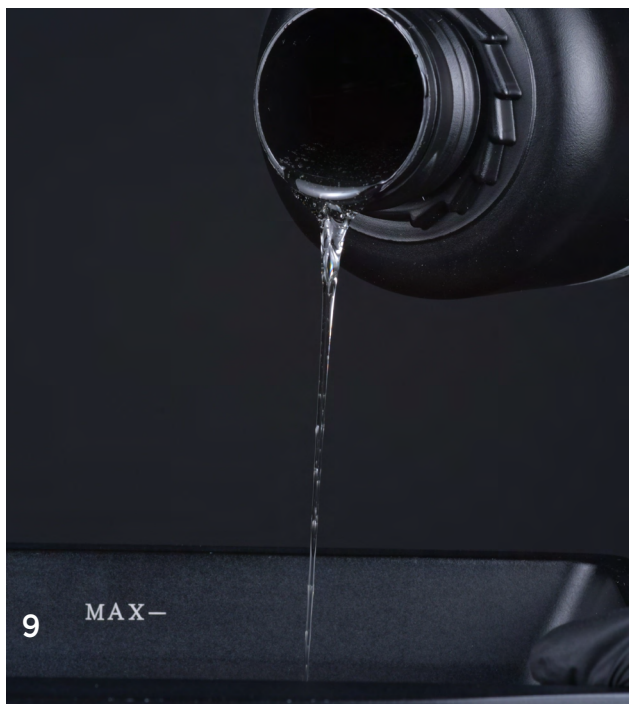
9 | Inserção da resina Voxelprint Split Tough no reservatório (VAT) da impressora 3D.
