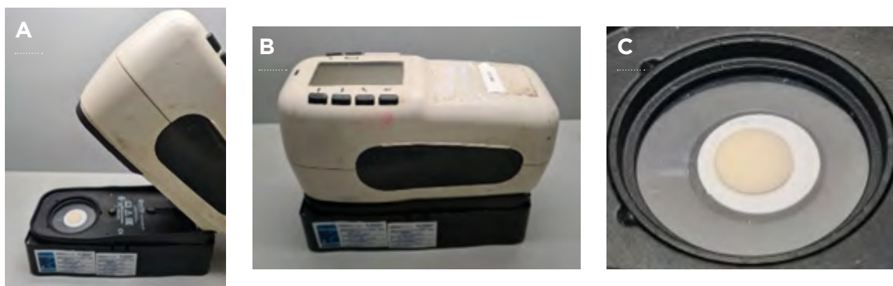
Imagens 2.2A, 2.2B e 2.2C: Equipamento de espectrofotometria utilizado para medição de cor dos corpos de prova.
