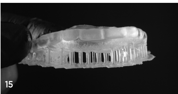
14, 15 e 16 | Remoção da peça da plataforma de impressão após o processo de limpeza. (15): Placa oclusal após limpeza, evidenciando superfície íntegra e livre de resíduos de resina (16): Etapa de remoção dos suportes estruturais da placa oclusal.
