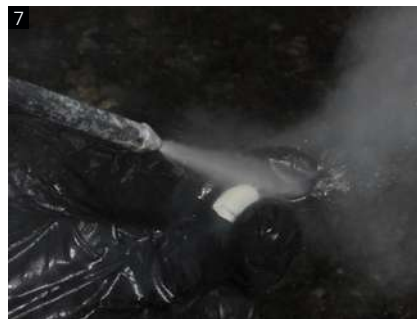
Fig. 3 - Peça assentada no modelo. Fig. 4 - Muralha de referência para controle do desgaste. Fig. 5 - Espaços para aplicação de resina de esmalte e efeitos. Fig. 6 - Limpeza da superfície com jato de óxido. Fig. 7 - Limpeza do óxido residual com jato de vapor.
