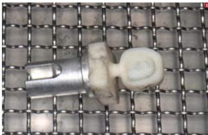
Fig b: lavagem da peça para remover resíduos do abrasivo
