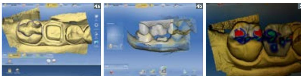
4a e 4b. Realizado o escaneamento digital dos preparos com scanner intraoral. 5. A peça do dente 47 foi criada diretamente no software (CAD).
