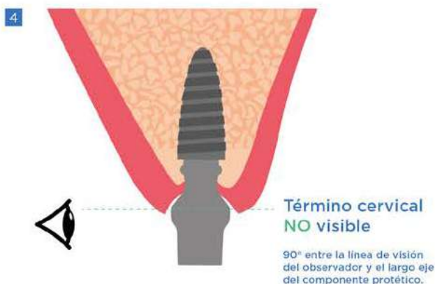
Fig 4: Durante la prueba del componente, la línea del término cervical NO debe ser visible al operador. Para ello, debe estar por debajo del nivel del tejido vestibular.
