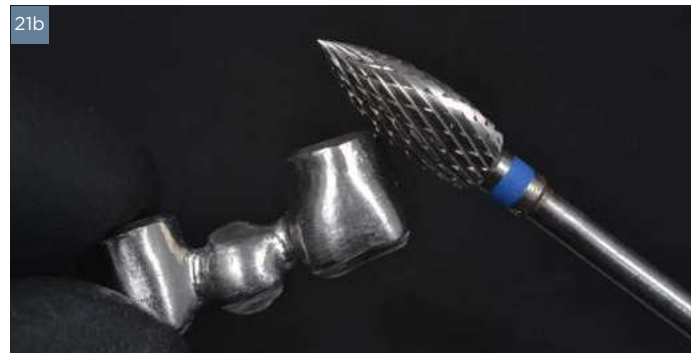
21b - Mecanizado de los márgenes de la Infraestructura metálica con fresa de tungsteno.
