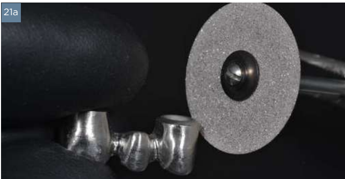
21a - Mecanizado de los márgenes de la infraestructura metálica con discos.
