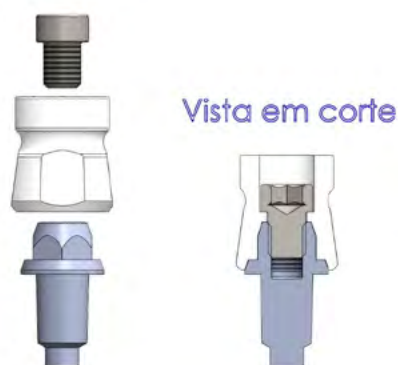
Figura 12: Desenho esquemático apresentando a conexão aparafusada do Transfer Multifuncional FGM e pilar protético.
