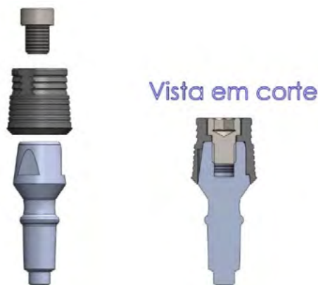
Figura 20: Desenho esquemático apresentando a conexão aparafusada do cilindro calcinável e pilar protético.
