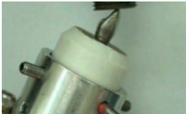
Figura 07: Imagem representativa da montagem de uma amostra posicionada a 30° do eixo de carregamento.
