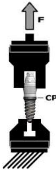
Figura 06: Desenho esquemático do ensaio de tração do conjunto implante e pilar protético.
